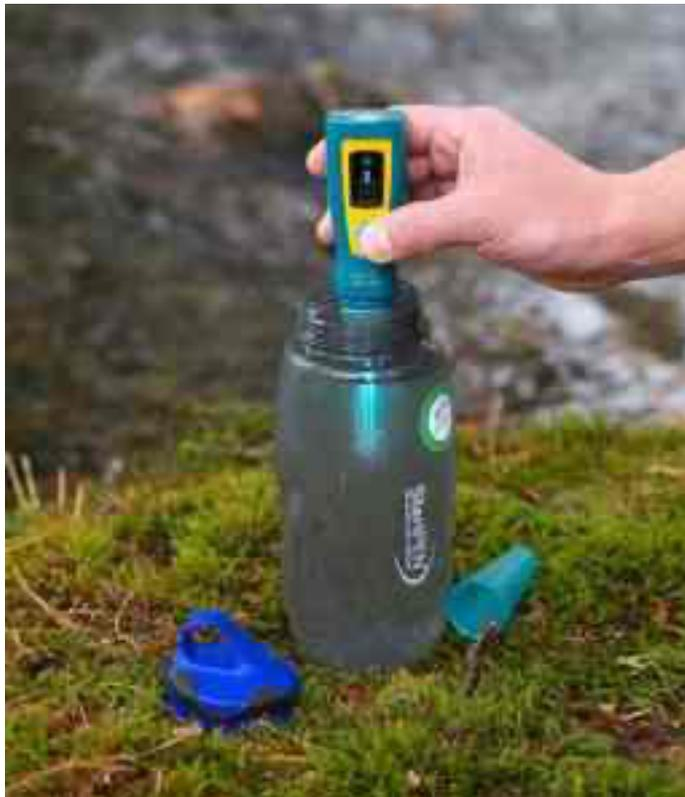
Mittels UV Strahlen kann unbehandeltes Wasser ebenfalls keimfrei gemacht werden. Das zum Einsatz kommende **UV-C-Licht** hat eine höhere Energie als das sichtbare Spektrum und tötet effektiv alle Mikroorganismen im Wasser ab <sup>4</sup>. Seit längerem gibt es diese Technologie nun auch für Trekker und Wanderer im Taschenformat. Bekanntester Hersteller ist dabei [SteriPEN\\*](#).
